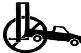
NUNCA LEVANTE NINGÚN VEHÍCULO DE NINGUNA MANERA CON MENOS DE LOS CUATRO (4) BRAZOS. LA CAPACIDAD NOMINAL DE CADA BRAZO DE ELEVACIÓN NO ES MAYOR DE UN CUARTO (1/4) DE LA CAPACIDAD DE ELEVACIÓN TOTAL.
