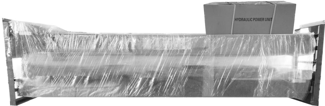
2. Mueva el elevador a un lado con una carretilla elevadora o polipasto y abra el embalaje exterior con cuidado, retire las piezas de la parte superior y del interior de la columna, saque la caja de piezas y verifique las piezas de acuerdo con la lista de piezas del envío.
