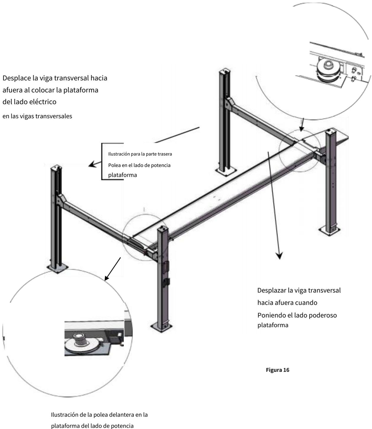
**2. Instale la placa de tope del neumático y los pernos de conexión:** Apriete la plataforma y la travesaño **1** con pernos. Apriete la placa de tope del neumático, la plataforma y la viga transversal **2** con perno.
